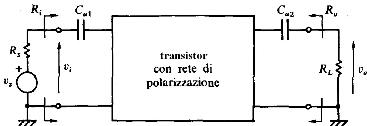
Fig. 11.14 – Schema generale di uno stadio di amplificazione
