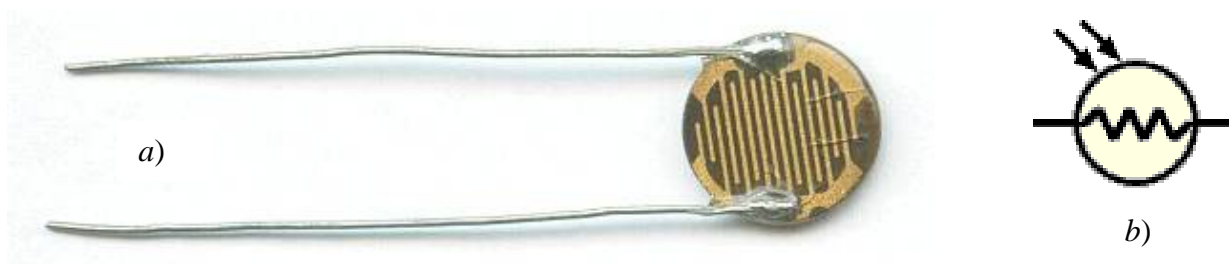
Fig. 8.12 – Fotoresistenza: a) foto; b) simbolo circuitale
